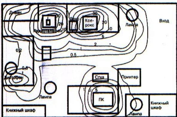
Пример карты распределения напряженности переменного электрического поля (в/м) частотой 50 Гц в помещении (Центр электромагнитной безопасности)
